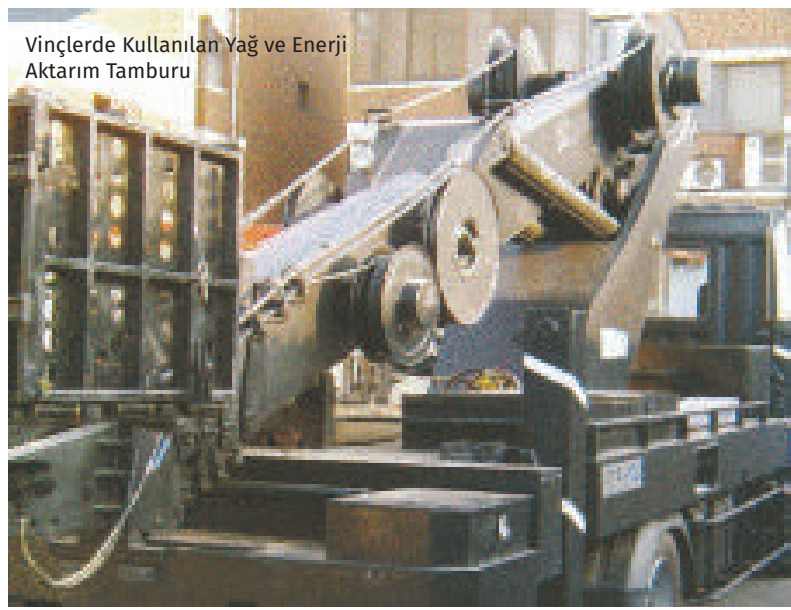
Vinçlerde Kullanılan Yağ ve Enerji Aktarım Tamburu
